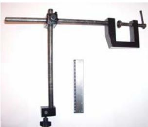
**Штатив** для закрепления печатающей головки на конвейере
